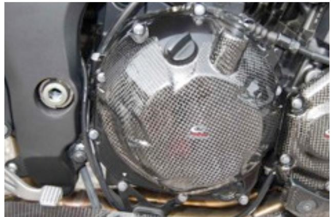
*À gauche, carter d'embrayage à sec ajouré sur un moteur bi-cylindre, à droite carter d'embrayage à bain d'huile fermé sur un moteur bi-cylindre.*
